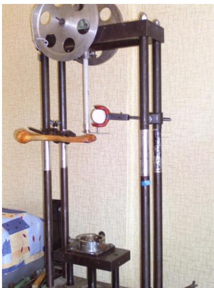
**Рисунок 4.3 Стенд для биомеханических исследований.**
