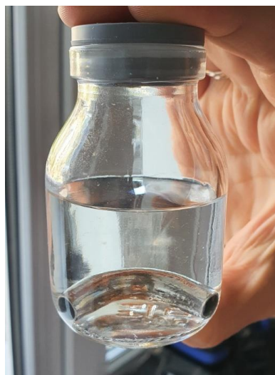
Рисунок 23. Металлический коннектор, опущенный в севофлюран, спустя 3 суток
