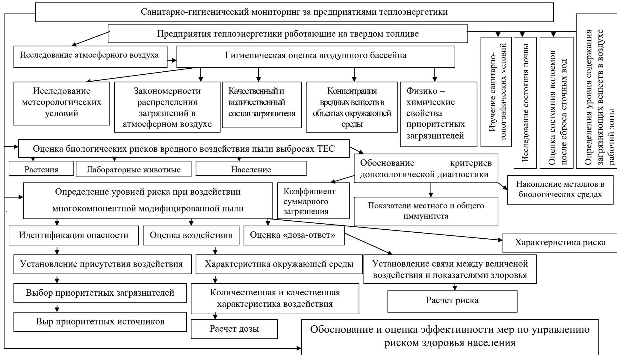
Рис. 9.2 Алгоритм оценки и управления риском действия многокомпонентной модифицированной пыли в выбросах ТЭС на объекты окружающей среды и здоровье населения
