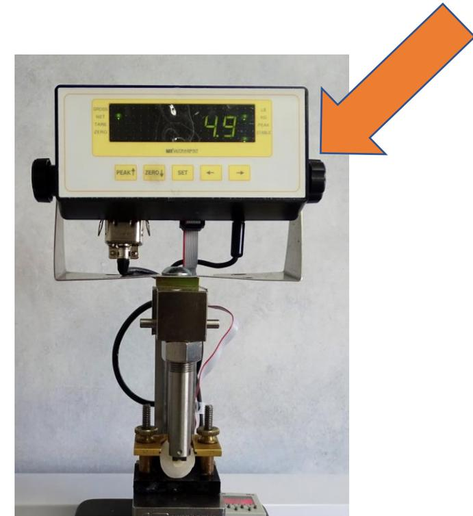
Значение максимальной нагрузки перед непосредственным разрушением образца (кг), отраженное на электронном дисплее испытательного аппарата UltraTester Bond Strength Testing Machine (Ultradent)
