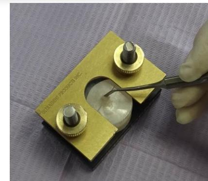
**Образцы**, в соответствии с требованиями стандартов ISO 29022:2013 и ГОСТ Р 59423-2021, **хранили в воде при температуре  $37 \pm 2$  °C в течение  $24 \pm 2$  ч** до начала проведения испытаний
