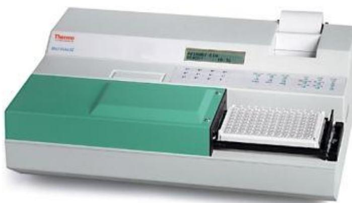
Рисунок 2.7. – Планшетный ридер Multiscan EX, «Thermo EC» (Финляндия)
